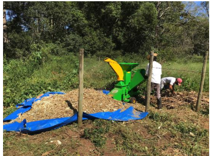
Bild 17: Kleiner biodynamischer Betrieb in Brasilien, der einen Häcksler zur Zerkleinerung der Maisstängel einsetzt.
