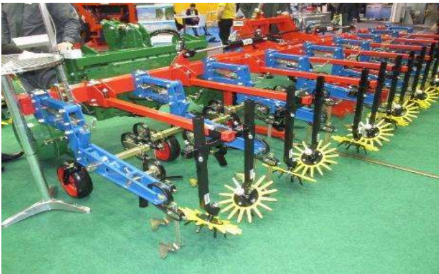
Abb.: Die Fingerräder sind natürlich auf den Rahmen des Unkrautstechers mit den Arbeitswerkzeugen für die Zwischenreihenbearbeitung kombiniert (Foto Brant).
