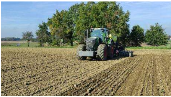
Abb.: Einsatz von Sämaschinen für die Aussaat in unbehandelte Böden für die Aussaat in lockere und vollständig behandelte Böden, bei denen das Gewicht der Maschine und die verwendete Zugkraft das Risiko tiefer Spurrillen mit sich bringen kann, in denen die Pflanzen nur schwer wachsen können (Foto Kasl).
