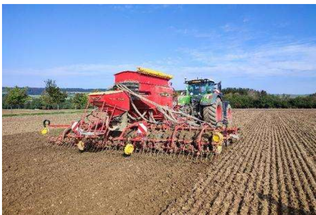
Abb.: Maschinen mit einem Bodenbearbeitungssystem für die Aussaat mit passiven Arbeitsgeräten (Foto Brant).
