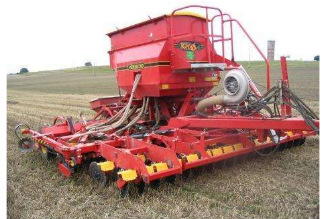
Abb.: Sämaschinen für die Aussaat in unbestellten Böden mit Scheibensäscharen (Foto Brant).
