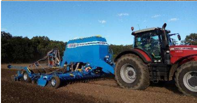
Abb.: Maschinen mit einem Bodenbearbeitungssystem für die Aussaat mit passiven Arbeitsgeräten (Foto Brant).
