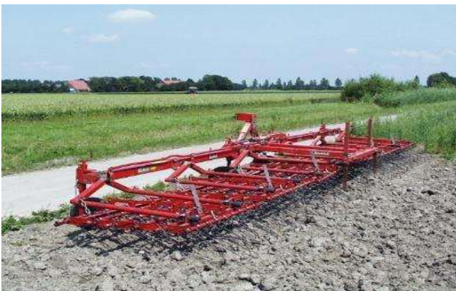
Abb.: Der Auflockerungs- und Entkrautungseffekt wird durch flexible Stäbe erzielt, die in mehreren Reihen am Maschinenrahmen angebracht sind (Foto Brant).
