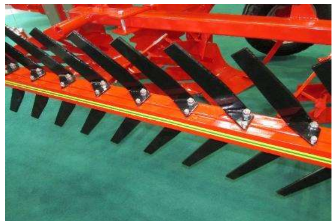
Abb.: Die Bearbeitung der Oberfläche des Pflugbodens kann mit Bodenstampfern direkt beim Pflügen erfolgen (Foto Brant).
