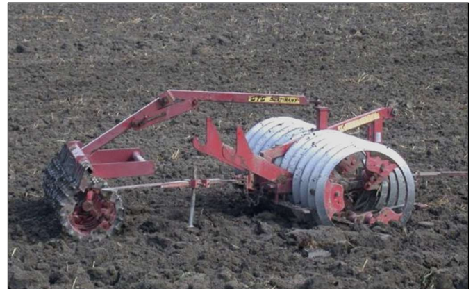
Abb.: Die Bearbeitung der Oberfläche des Pflugbodens kann mit Bodenstampfern direkt beim Pflügen erfolgen (Foto Brant).
