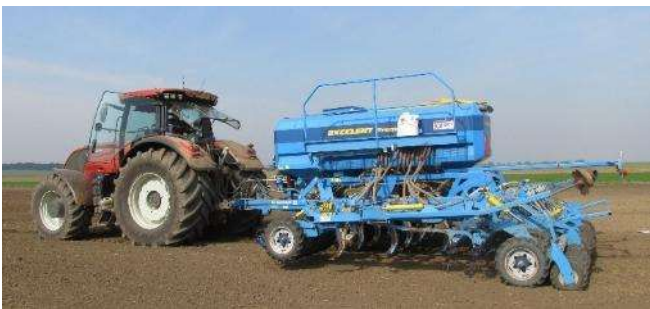
Abb.: Sämaschinen für die Aussaat in bearbeiteten oder teilweise bearbeiteten Böden mit Meißeln (Foto Brant).
