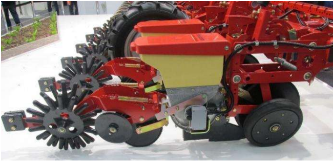
Abb.: Sämaschinen für die Aussaat in aufbereiteten oder teilweise aufbereiteten Böden, die mit Säscharen mit Flügeln ausgestattet sind (Foto Brant).
