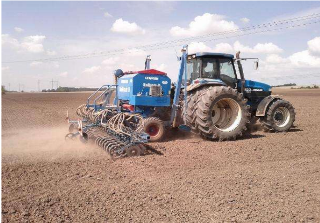
Abb.: Sämaschinen ohne Bodenvorbereitungsabschnitte erfordern in der Regel eine gute Bodenvorbereitung vor der Aussaat (Foto Brant).
