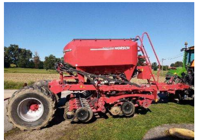
Abb.: Eine erweiterte Gruppe von Sämaschinen, die mit Maschinen mit aktiv arbeitenden Werkzeugen kombiniert sind (Foto Drapac und Brant).
