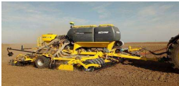
Abb.: Sämaschinen ohne Bodenvorbereitungsabschnitte erfordern in der Regel eine gute Bodenvorbereitung vor der Aussaat (Foto Brant).
