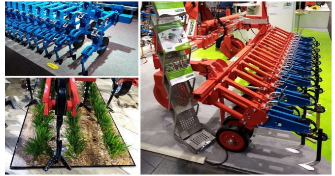
Abb.: Für den Anbau von Kulturen, die in engen Reihen gesät werden, werden hauptsächlich Unkrautstecher mit unterschneidenden Pfeilscharen verwendet (Foto Brant).
