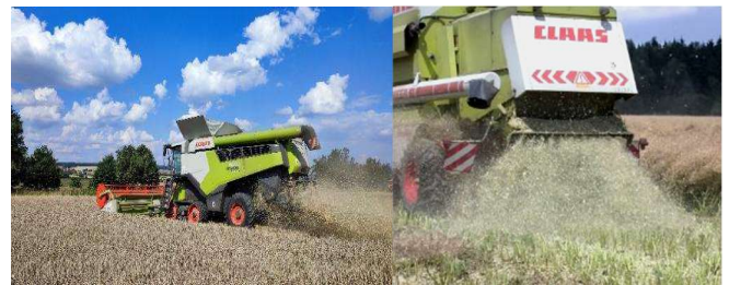
Abb.: Die gleichmäßige Verteilung des Strohs auf der Parzelle ist wichtig für eine perfekte Einarbeitung in den Boden (Foto Brant).
