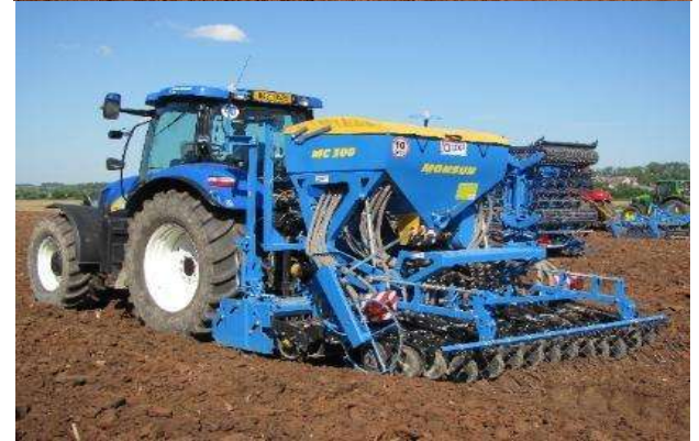
Abb.: Eine erweiterte Gruppe von Sämaschinen, die mit Maschinen mit aktiv arbeitenden Werkzeugen kombiniert sind (Foto Drapac und Brant).
