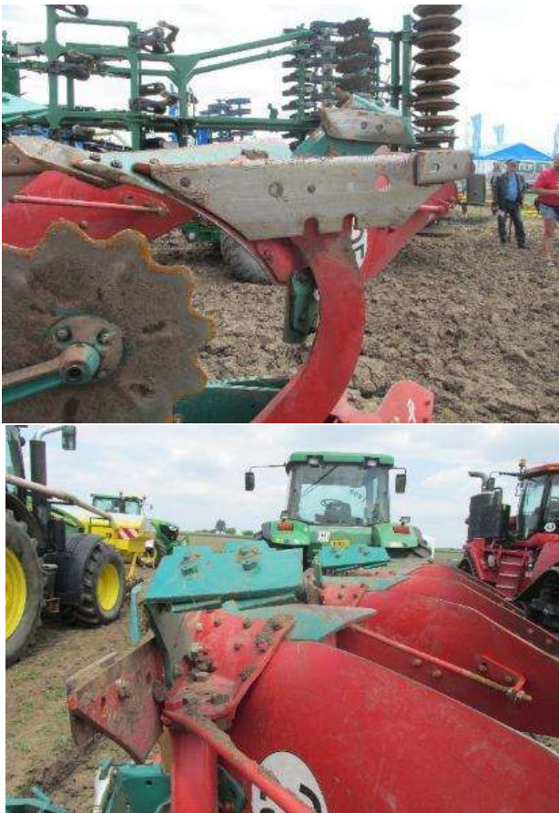
Abb.: Position des Abstreifers am Pflugkörper (Foto Brant).
