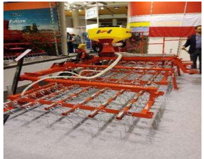
Abb.: Die Kreiseleggen können mit Saatgutschalen für die Aussaat von Zwischenfrüchten oder anderen Feststoffen ausgestattet werden (Foto Brant).
