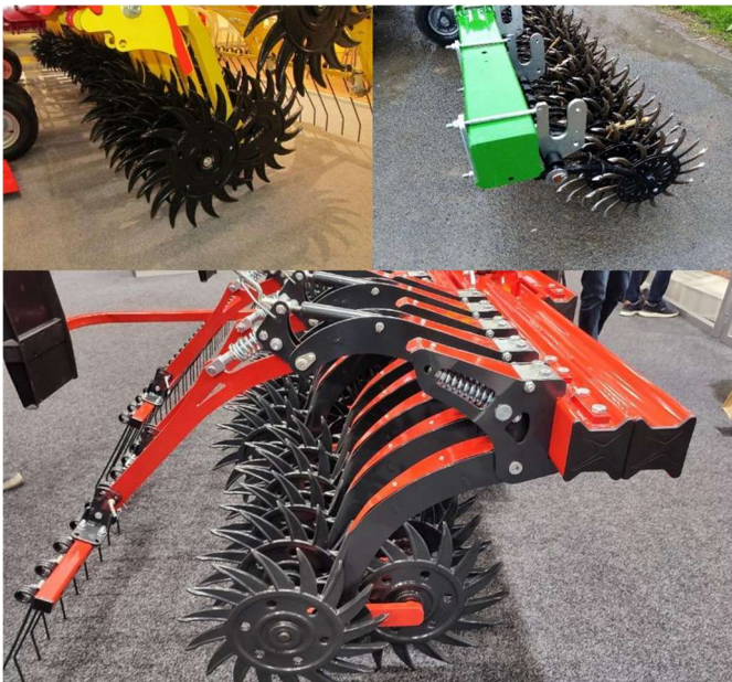
Abb.: Die Sternscheiben sorgen dafür, dass das Unkraut aus dem lockeren Boden herausgezogen wird, indem es untergraben und mit dem Arbeitsgerät weggeworfen wird (Foto Brant).
