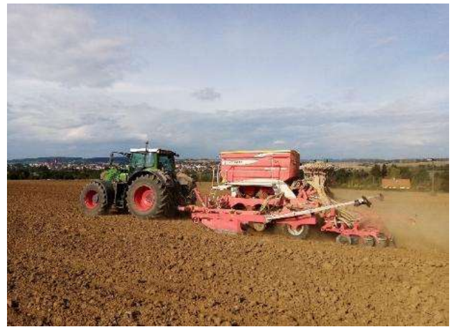
Abb.: Die Arbeitsabschnitte der Sämaschinen für die Bodenvorbereitung sorgen für die Einebnung der Bodenoberfläche, die Bildung des Saatbetts und die geeignete räumliche Anordnung des Bodens über dem Saatbett (Foto Brant).
