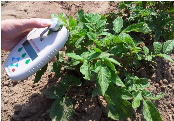
Abbildung 4: Bestimmung des Chlorophyllindex in den Blättern des Kartoffelstamms mit dem Chlorophyllmessgerät CCM 200 Plus
