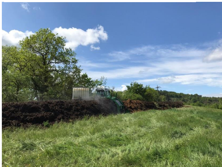
Mechanisches Wenden einer Kompost-Feldmiete auf der Bannmühle, Odernheim am Glan (Foto: J. Enderes)
